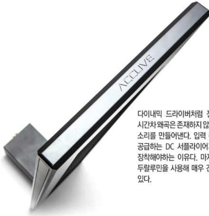
다이내믹 드라이버처럼 진동판이 유선형이 아니라 평면이기 때문에 시간차 왜곡은 존재하지 않으며 매우 민첩하고 빠르게 공기압을 변화시켜 소리를 만들어낸다. 입력 쪽에는 트랜스포머가 내장되어 있으며 DC를 공급하는 DC 서플라이어가 내장된다. 좌, 우 스피커에 DC 어댑터를 장착해야하는 이유다. 마지막으로 캐비닛이라고 할 수 있는 프레임은 두랄루민을 사용해 매우 견고하게 제작해 공진에 적극적으로 대처하고 있다.
